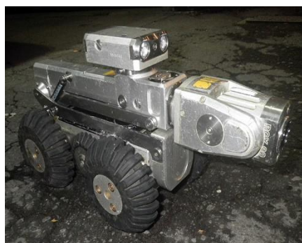
写真：下水道管内カメラ
