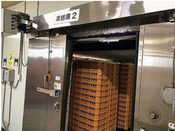
写真：当社工場内の冷凍おはぎ用の凍結庫
